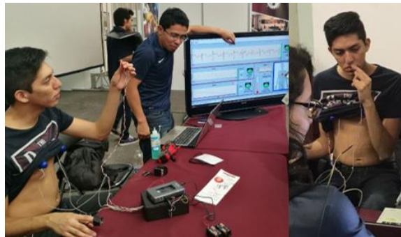
Fig. 9. Tarjeta myRIO-1900, con los sensores y circuitos diseñados mostrando en LabVIEW las señales monitoreadas.
